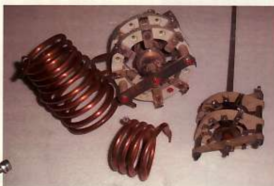
Foto 5: Keramische schakelaars, en het koperen buis voor de spoel.
